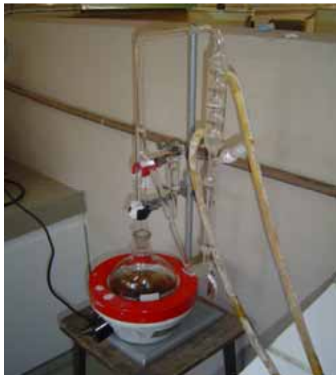
FIGURA 9 – Destilação de óleos essenciais para determinação quantitativa Fonte: BRANDÃO, 2007.
